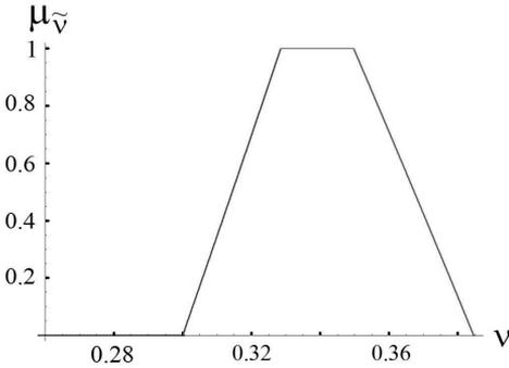
Рис. 3. Функция принадлежности для нечеткой характеристики  $\tilde{\nu}$  круглой плиты.
