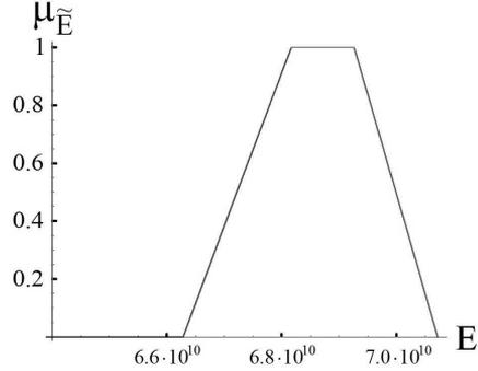
Рис. 4. Функция принадлежности для нечеткой характеристики  $\tilde{E}$  круглой плиты.
